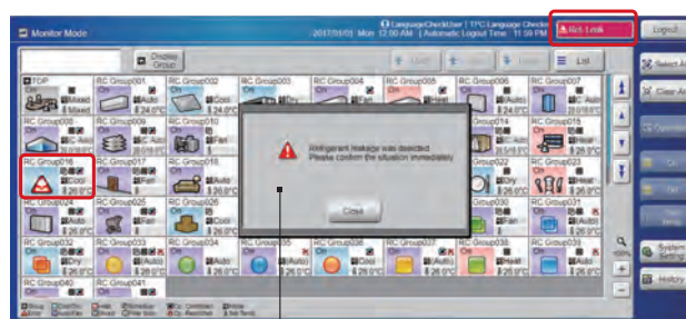
Wyskakujące okienko z informacją o wycieku
